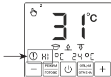
Рис. 18. Замыкание датчика обогрева
